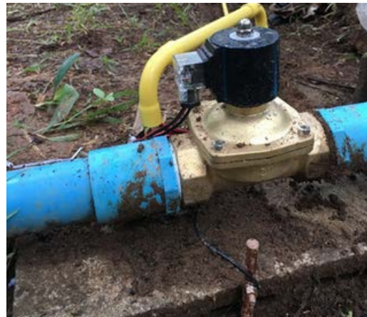
ภาพเซนเซอร์วัดความชื้น อุณหภูมิ ปุ๋ย (N-P-K) ในดิน และโซลินอยด์วาล์วควบคุมการเปิดปิดน้ำ
