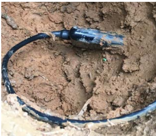
ภาพเซนเซอร์วัดความชื้น อุณหภูมิ ปุ๋ย (N-P-K) ในดิน และโซลินอยด์วาล์วควบคุมการเปิดปิดน้ำ
